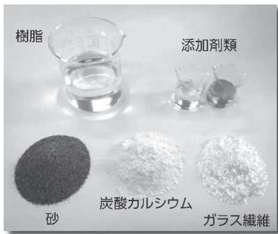
写真-1 レジンコンクリートパネルの材料
